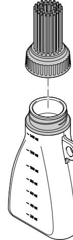
(de) Immer im unteren Flaschenbereich drücken, nicht im oberen Bereich in der Nähe des Gewinderings! Sonst besteht Auslaufgefahr!
